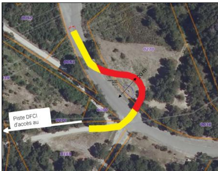
Photo 8 : Tracé proposé pour permettre la création d'une piste lourde permettant l'accès à la piste DFCI par les camions.
