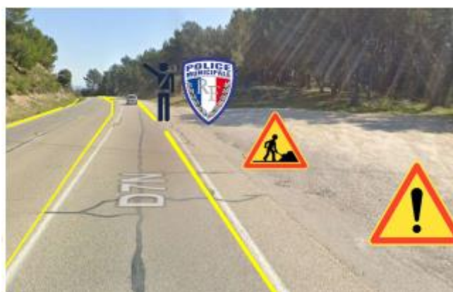
Photo 11 : Vue projetée depuis la RD7n vers le sud – 300m avant l'insertion des camions – avec le dispositif signalétique (panneau, marquage sol, agent de régulation de circulation).
